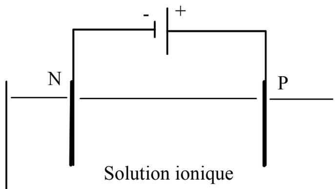
Deux plaques P et N sont plongées dans un liquide qui contient des ions.
